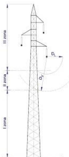
Slika 3. Podjela stupa nadzemnog voda na zone
